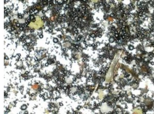
*Мелкодисперсная пыль, образующаяся при обработке кругами с обычным зерном*
