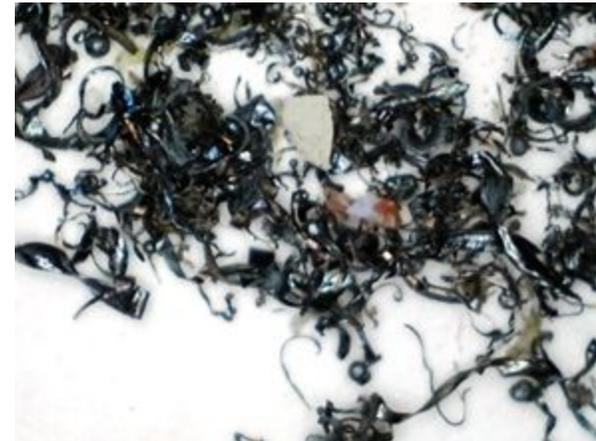
*Стружка, образующаяся при обработке кругами с зерном точной формы 3M™*
